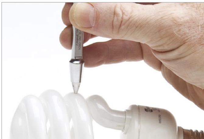
Mesure de verre mince avec la sonde Sonopen® V260-SM
