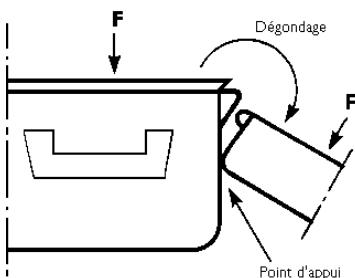
Pour remonter le couvercle, placer les gonds dans leur logement et exercer une forte pression de l'arrière vers l'avant du couvercle jusqu'à enclenchement de celui-ci
