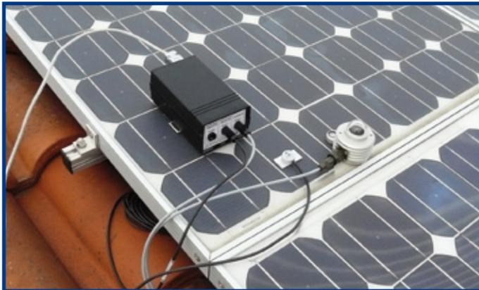
Le **GREENTEST** dispose d'un ensemble d'accessoire de communication très utile pour la transmission des résultats de mesures sur de grandes installations. Un module déporté « REMOTE » permet la transmission en temps réel des données jusqu'à 100 m de distance. Il fonctionne soit avec un kit d'adaptateurs série Bluetooth, jusqu'à 100 m de distance, soit avec un câble série 15 m avec connecteur RS232 mâle/mâle 9 broches.
