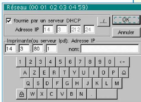
La configuration de la communication est des plus simple puisque, dans la plupart des cas, l'adresse IP de l'instrument est fournie automatiquement par le serveur local ; il suffit d'entrer l'adresse de l'imprimante à utiliser.
